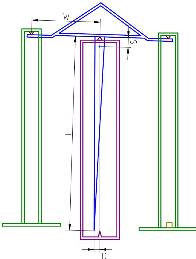
1. Das Bild zeigt das Schema einer Analysewaage. Der Abstand vom zentralen Auflager zu den Auflagern der Waagschalen (grün) sei  $W = 10 \text{ cm}$ . Der Zeiger am Balken (blau) habe die Länge  $L = 25 \text{ cm}$ . Der Balken mit Zeiger habe die Masse  $M = 100 \text{ g}$ . Ohne aufgelegte Gewichte schwingt der Zeiger um die Mittelstellung. Wenn auf die rechte Schale ein Gewicht von  $\Delta m = 10 \text{ mg}$  aufgelegt wird, dann verschiebt sich die Zeigerstellung um  $D = 8 \text{ mm}$ .
