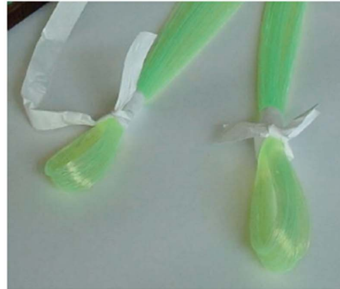
Szintillierende Fasern für den MINOS Detektor (Fermilab), Faserdurchmesser 1 mm, min. Biegeradius 1.7 cm.
