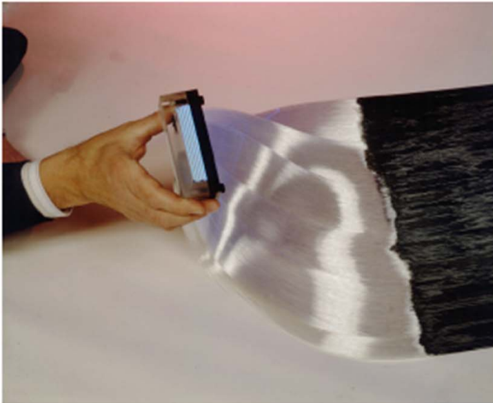
Szintillierende Fasern aus dem em. Kalorimeter des CHORUS Detektors (SPS, CERN)
