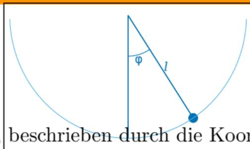
Ein Freiheitsgrad, beschrieben durch die Koordinate  $\varphi$ . Zwei Kräfte, Gravitation und Faden,
