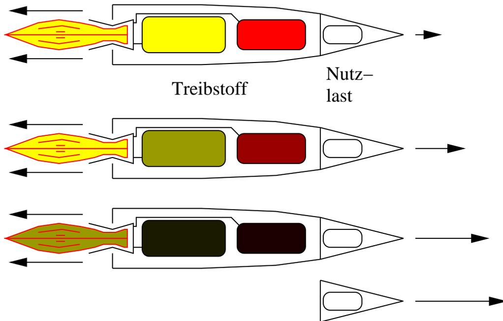
Als Beispiel für eine Bewegungsgleichung untersuchen wir die Raketengleichung, welche die Bewegung von Raketen beschreibt. Bei einer konstanten Brennrate  $\dot{m}$  entströmen während der Brennzeit  $t_B$  die heißen Gase der Düse mit einer Geschwindigkeit  $v_0$ . Dann lautet der Ausdruck für die Masse der Rakete
