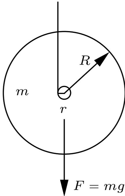
Das Maxwell-Rad ist eine kreisförmige Scheibe, bzw. ein Zylinder mit Masse  $m$  und Radius  $R$  und hat ein Trägheitsmoment  $J = (1/2)mR^2$ . Bekannter ist es unter dem Namen Jojo. Es rollt auf einer dünnen Achse (Radius  $r$ ) an einer Schnur ab. Das heißt, dass an der Abrollstelle ein Drehmoment  $M$  wirkt,
