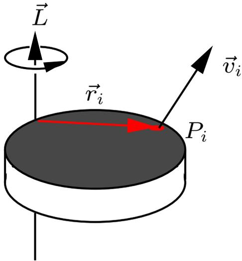
$$\vec{r} \times \vec{\omega} \times \vec{r} = (\vec{r} \cdot \vec{r})\vec{\omega} - (\vec{r} \cdot \vec{\omega})\vec{r}$$
