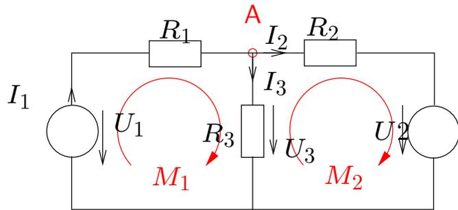
Im Netzwerk links treten drei Spannungen und drei Ströme auf, linear unabhängige Gleichungen gibt es für den Knoten A und die Maschen  $M_1$  und  $M_2$ . Die Gleichungen für den Knoten unterhalb von A und für die Gesamtmasche sind nicht linear unabhängig von den anderen drei Gleichungen. Drei Unbekannte, drei linear unabhängige Gleichungen.
