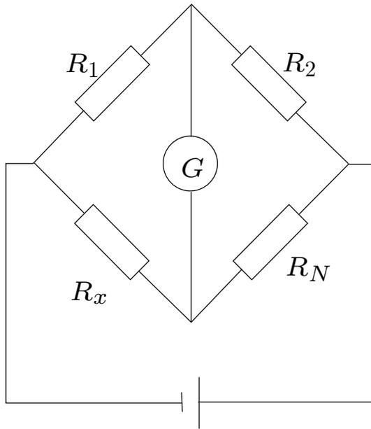
Ein unbekannter Widerstand  $R_x$  kann mit Hilfe einer Wheatstoneschen Brücke sehr genau vermessen werden. Dazu braucht es zwei bekannte Widerstände  $R_1$  und  $R_2$  (oft die zwei Hälften eines Widerstandsdrahtes) und einen variablen Widerstand  $R_N$ . Dieser wird variiert, bis über die Brücke  $G$  kein Strom mehr fließt bzw. über der Brücke keine Spannung herrscht.
