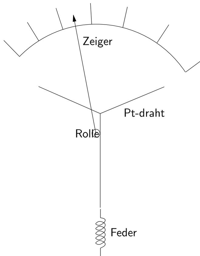
Die Ausdehnung eines Platinleiters durch die Joulsche Erwärmung wird in (heute nicht mehr gebräuchlichen) Hitzdrahtinstrumenten ausgenutzt. Der Pt-Draht wird mit einer Feder immer gespannt gehalten, die Kontraktion der Feder wird über eine Rolle abgenommen und angezeigt. Der Vorteil dieser Instrumente liegt darin, dass sie nur auf  $I^2$  empfindlich sind und deshalb das Vorzeichen des Stroms keine Rolle spielt.
