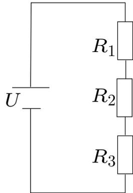
In diesem Beispiel sagen die Kirchhoffschen Regeln, dass  $U = I \cdot (R_1 + R_2 + R_3)$ , was impliziert, dass der Gesamtwiderstand der Anordnung
