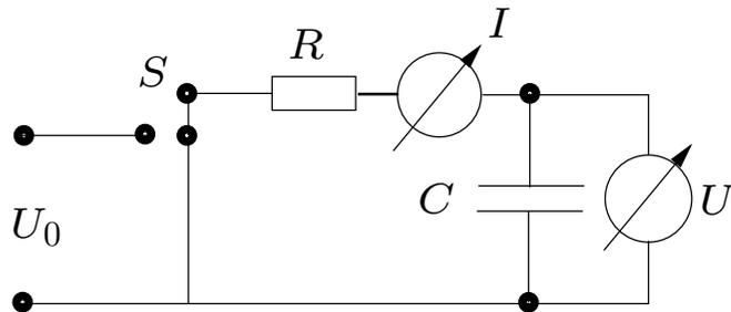
Nun wird der Schalter  $S$  umgekippt und der Kondensator entladen. Dabei müssen alle Ladungen  $Q$  des Kondensators als Strom abfließen,
