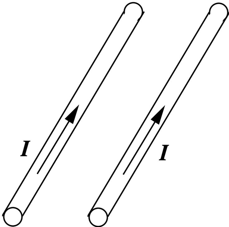
Ein Ampère ist die Stromstärke, die zwei stromdurchflossene unendlich lange, gerade in einem Abstand  $d$  von einem Meter von einander im Vakuum angeordnete Leiter aufeinander eine Kraft von  $2 \cdot 10^{-7}$  N ausüben lässt.
