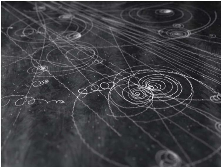
Bringt man die Nebelkammer zudem in ein starkes Magnetfeld, so werden die Trajektorien der geladenen Teilchen wegen der Lorentzkraft zu Kreisbahnen verbogen. Spiralen deuten einen Energieverlust an weil die Teilchen an das Medium Energie verlieren, somit langsamer werden und dann nach innen spiralen.
