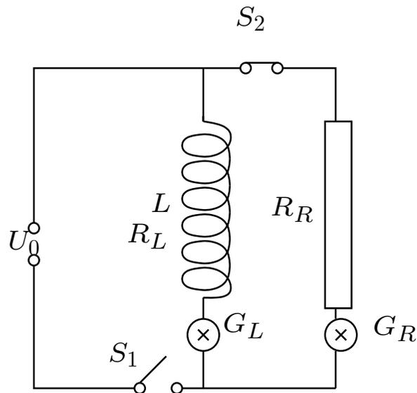
Nun wird der Schalter  $S_1$  geöffnet, d. h.  $U_0(t = 0) = 0$  und  $I_L(t = 0) = I_L(t < 0) = I_0$ . Dann gilt nach der Maschenregel und Lenzschen Regel
