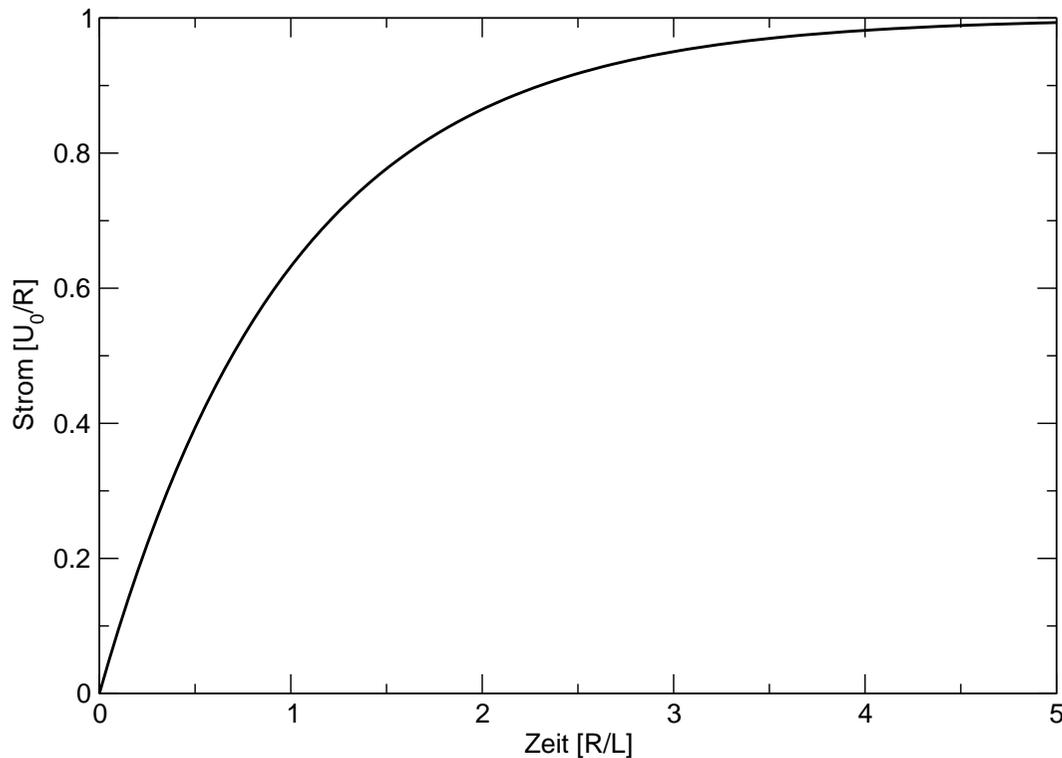
Der Strom steigt rasch an und schmiegt sich asymptotisch an den Wert  $U_0/R$ . Die Zeitverzögerung gegenüber der rein ohmschen Situation kann qualitativ sichtbar gemacht werden, indem zu Beginn auch der Schalter  $S_2$  geschlossen wird. Dann leuchtet Glühbirne  $G_L$  erst nach  $G_R$  auf. Über die Spule fließt der Strom  $I_L = U_0/R_L$ , über den Widerstand  $I_R = U_0/R_R$ .
