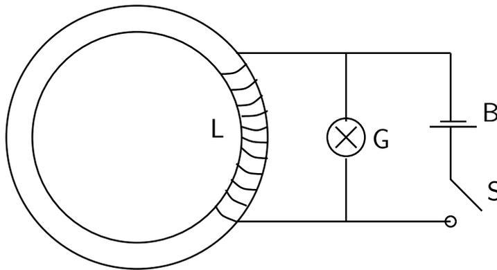
Fließt durch eine Spule ein Strom, so liegt die Vermutung nahe, dass das dadurch entstehende Magnetfeld bei Veränderung eine Spannung induzieren könnte. Diese Spannung ist nach der Lenzschen Regel entgegengesetzt zur Änderung in der angelegten Spannung. In der Anordnung links wird die Glühbirne G kurz aufleuchten, wenn der
