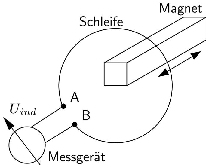
Wir haben gesehen, dass sich in der Konfiguration links zwischen den Punkten A und B eine Spannung  $U_{\text{ind}}$  aufbaut.
