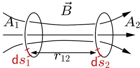
Wie beeinflussen sich zwei Stromkreise gegenseitig? Nach Biot-Savart erzeugt der stromdurchflossene Stromkreis 1 im Punkt  $P(r_{12})$  ein Magnetfeld welches einen magnetischen Fluss durch die durch die Leiterschleife  $s_2$  aufgespannte Fläche  $A_2$  bewirkt
