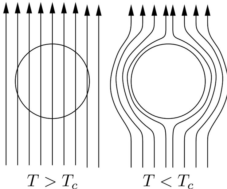
Supraleiter verhalten sich wie perfekte Diamagnete. Unterhalb einer materialabhängigen kritischen Temperatur  $T_c$  wird ein äußeres Magnetfeld aus dem Supraleiter herausgedrängt. Wie ein perfekter Diamagnet wird der supraleitende Körper dabei aus dem Magnetfeld gedrängt, bzw. scheint darin zu schweben - die Gravitationskraft wird durch die entstandene Inhomogenität des Feldes und die daraus folgende "Gradientenkraft" kompensiert.
