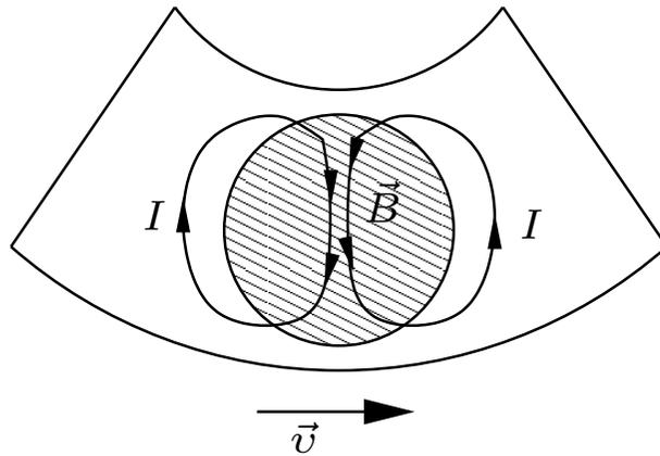
Die in ausgedehnten Leitern induzierten Ströme nennt man **Wirbelströme**. Sie fließen, wie wir jetzt gesehen haben, immer entgegengesetzt zu den induzierenden Größen. Damit kann man Wirbelströme sehr gut als Bremse verwenden. Die Ströme entstehen durch die auf die Leiterelektronen wirkende Lorentzkraft. Die entstehende Joulsche Wärme entzieht der Bewegung Energie.
