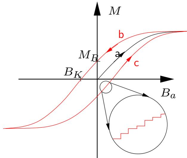
Misst man die Magnetisierungskurve eines Ferromagneten sehr genau aus, so findet man, dass sie aus vielen kleinen **Barkhausen-Sprüngen** besteht. Diese erklären sich durch das Umklappen der magnetischen Momente von einzelnen sog. **Weiss'schen Bezirken**, die je zwischen  $10^8$  und  $10^{12}$  Magnetone enthalten.
