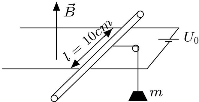
Ein leitender Stab ( $R = 0,1 \Omega$ ) liege auf zwei leitenden, parallelen Schienen ( $R \simeq 0$ ) mit 10 cm Abstand, an welchen eine Spannung  $U_0 = 15 \text{ V}$  liegt. Der Stab ist über ein Seil mit einer Masse  $m = 1,2 \text{ kg}$  verbunden. Berechnen Sie die Geschwindigkeit  $v_0$  des Stabs, mit welcher er sich stationär bewegt, wenn ein homogenes Magnetfeld  $B_0 = 10 \text{ kGauß}$  senkrecht durch die Schienenebene tritt. [ $v_0 = 32,3 \text{ m/s}$ ]
