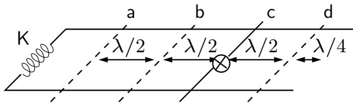
Zwei Drähte der Länge  $l$  sind im Abstand  $d \ll l$  parallel zueinander aufgespannt. An der Kopplungsschleife  $K$  wird die Leitung induktiv an den Schwingkreis eines HF-Generators angekoppelt. Die Spannung  $U(t, z)$  über den Drähten ist nun sowohl vom Ort ( $z$ -Achse entlang den Drähten) wie auch von
