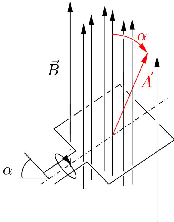
Wir haben letzte Woche gesehen, dass in einer in einem homogenen Magnetfeld bewegten Leiterschleife eine Spannung induziert wird. Das **Faradaysche Induktionsgesetz** lässt sich ausnutzen, um eine Wechselspannung zu induzieren. Ist  $\alpha(t) = \omega \cdot t$  der zeitabhängige Winkel zwischen Magnetfeld und Spulennormalen, so finden wir:
