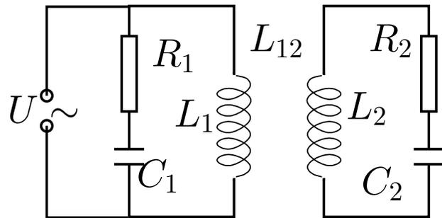
Auch elektrische Schwingkreise können aneinander gekoppelt werden, z. B. durch eine induktive Kopplung (Anordnung links), aber auch durch kapazitive (durch einen Kondensator) oder galvanische Kopplung (durch einen Widerstand).
