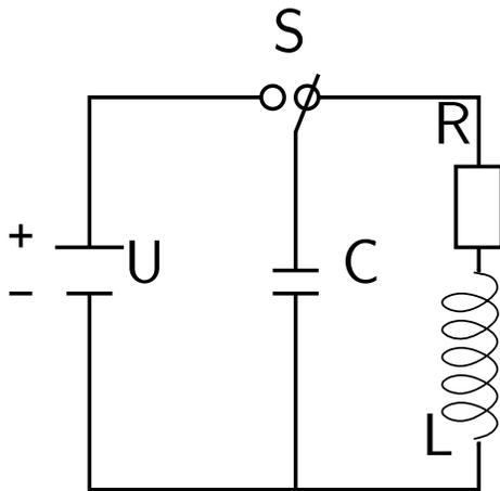
Nach Aufladen des Kondensators C wird der Schalter S in die hier angedeutete Lage gekippt. Dadurch fließt ein Strom durch den Widerstand R und die Spule L. Zur Zeit  $t = 0$  sei die Ladung  $Q_0$  auf dem Kondensator  $Q_0 = CU_{C,0}$  und nach Kirchhoff gilt
