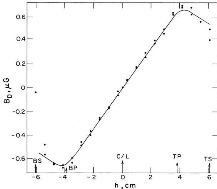
Bartlett und Corle (Phys. Rev. Lett., **55**, 59–62, (1985)) haben nachgewiesen, dass im Innern des Kondensators tatsächlich ein Magnetfeld herrscht. Der durch den Kondensator fließende virtuelle Strom (die Ladungsänderung an den beiden Platten führt zu einer Veränderung des elektrischen Feldes) induziert ein Magnetfeld. **Magnetfelder entstehen durch Ströme und zeitlich variable elektrische Felder.**
