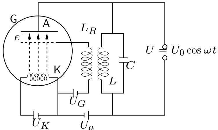
Durch die induktive Kopplung zwischen der Schwingkreisspule  $L$  und der Rückkopplungsspule  $L_R$  wird die Stromzufuhr aus der externen Gleichspannungsquelle  $U_a$  gesteuert. Eine Schwingung im  $LC$ -Schwingkreis induziert in der Rückkopplungsspule  $L_R$  einen Wechselstrom, welcher die negative Vorspannung  $U_G$  des Gitters in der Triode in einer Weise modu-
