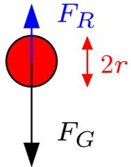
Fällt eine Kugel durch Luft, so wirkt neben der Erdanziehung auch eine Reibungskraft, der Luftwiderstand. Nach Stokes beträgt die Reibungskraft
