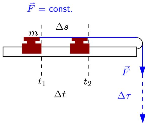
Wir verwenden die Luftkissenbahn und überprüfen das Verhalten der Geschwindigkeitsänderung pro Zeiteinheit bei verschiedenen Massen der "Schiffchen".
