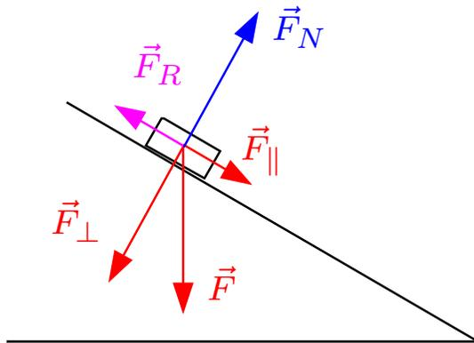
Wir haben bereits gesehen, dass ein Körper sich beschleunigt bewegt, wenn eine Kraft angreift. Damit sich ein Körper nicht beschleunigt wird, muss die Summe der angreifenden Kräfte verschwinden. Bei einem unbewegten Klotz auf einer schiefen Ebene wirkt die sog. **Normalen-Kraft**,  $\vec{F}_N = -\vec{F}_{\perp}$  entgegen und die Reibungskraft
