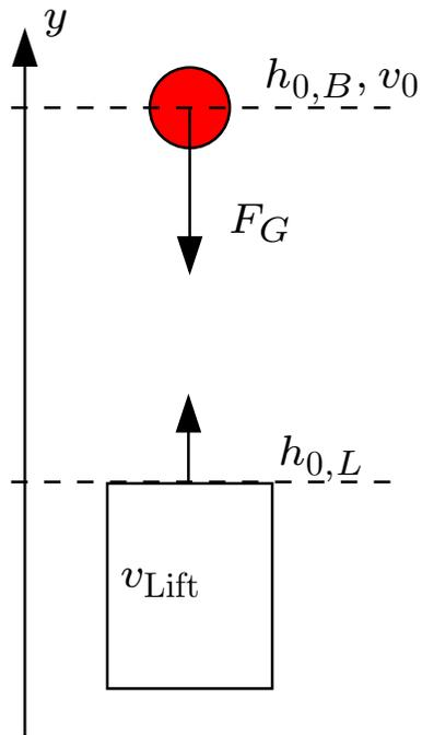
Am oberen Ende eines nach oben offenen Liftschachtes wird ein Ball fallengelassen. Von unten nähert sich ein Lift mit konstanter Geschwindigkeit  $v_{\text{Lift}} = 1 \text{ m/s}$ . Wann und in welcher Höher treffen sie sich, wenn der Ball losgelassen wurde, als sich der Lift genau 20m unterhalb des Balls befand?
