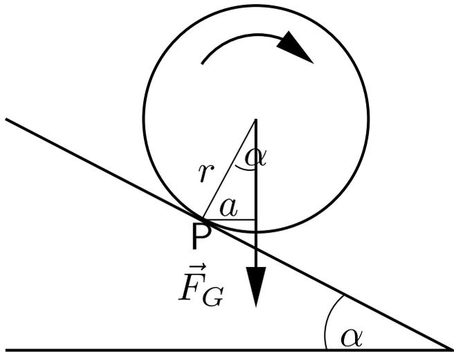
Drehmoment  $F_G a = F_G r \sin \alpha$  wird kompensiert durch Drehmoment aufgrund der Reibungskraft
