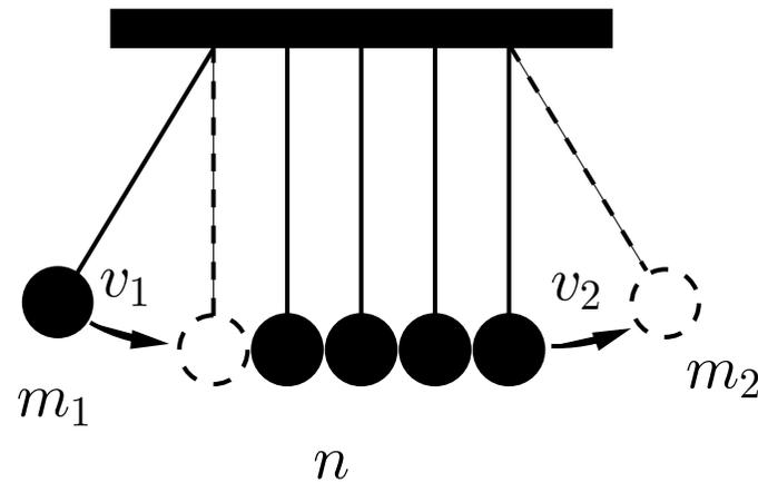
$$n_1 m_1 v_1 = n_2 m_2 v_2 \quad (\text{Impulssatz}); \quad \frac{n_1}{2} m_1 v_1^2 = \frac{n_2}{2} m_2 v_2^2 \quad (\text{Energiesatz}).$$
