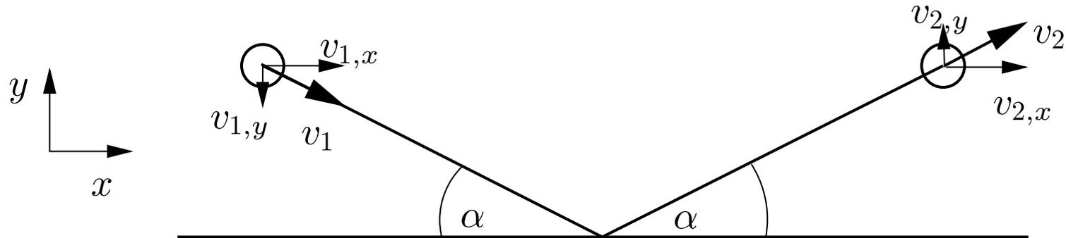
Überlagerung einer Bewegung entlang von  $x$  mit einer Reflexion an einer Wand.
