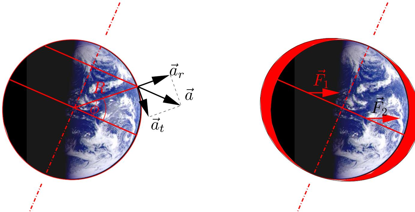
Die Tangentialkomponente führt zur Ausbildung von “Wülsten” entlang des Äquators. Diese werden verschieden stark von der Sonne angezogen, was einem Drehmoment auf die Erde gleichkommt. Folge: der Drehimpuls der Erde bleibt nicht konstant. Die Erdachse präzessiert einmal in ca. 26'000 Jahren.
