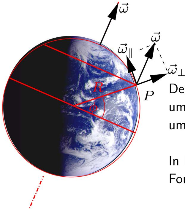
Die Rotation der Erde macht sich in einem Punkt  $P$  bemerkbar als eine Überlagerung einer Rotation der Ebene um  $\vec{\omega}_{\perp}$  und eine weitere Rotation um  $\vec{\omega}_{\parallel}$ .
