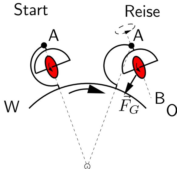
Die Erdanziehung  $\vec{F}_G$  zeigt immer zum Erdmittelpunkt. Dadurch erfährt der Kreisel ein Drehmoment, welches die Kreiselrichtung um genau den Winkel verdreht, der notwendig ist, um den Kompass wieder nach Norden zeigen zu lassen.
