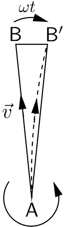
Ein Massenpunkt bewegt sich auf einer rotierenden Scheibe von A aus mit der Geschwindigkeit  $\vec{v}$  nach B hin. Infolge der Rotation erreicht er aber nach einer Zeit  $t$  den Punkt B'. Für mitrotierende Beobachter scheint der Massenpunkt also einer Kraft ausgesetzt, die während der Zeit  $t$  gewirkt hat.
