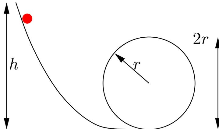
Ein Ball rollt reibungsfrei die Schiene herunter in einen Looping. Wie hoch muss seine Ausgangshöhe  $h$  sein, wenn er in Ruhe startet und sehr klein ist?
