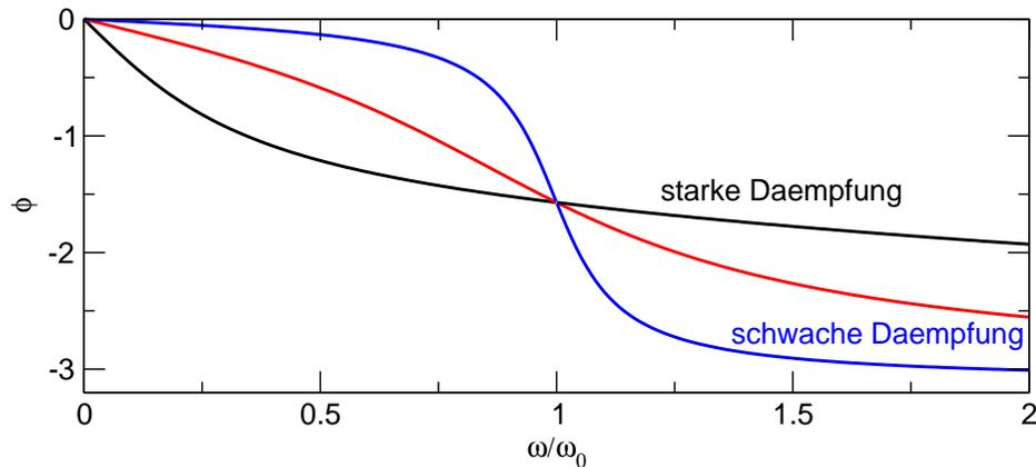
Oft wird eine Schwingung angeregt oder **erzwungen** durch eine ortsunabhängige, periodische Kraft  $F = F_0 \sin(\omega t + \phi)$ . Die Schwingungsgleichung erhält nun eine rechte Seite (wird inhomogen) und lautet dann
