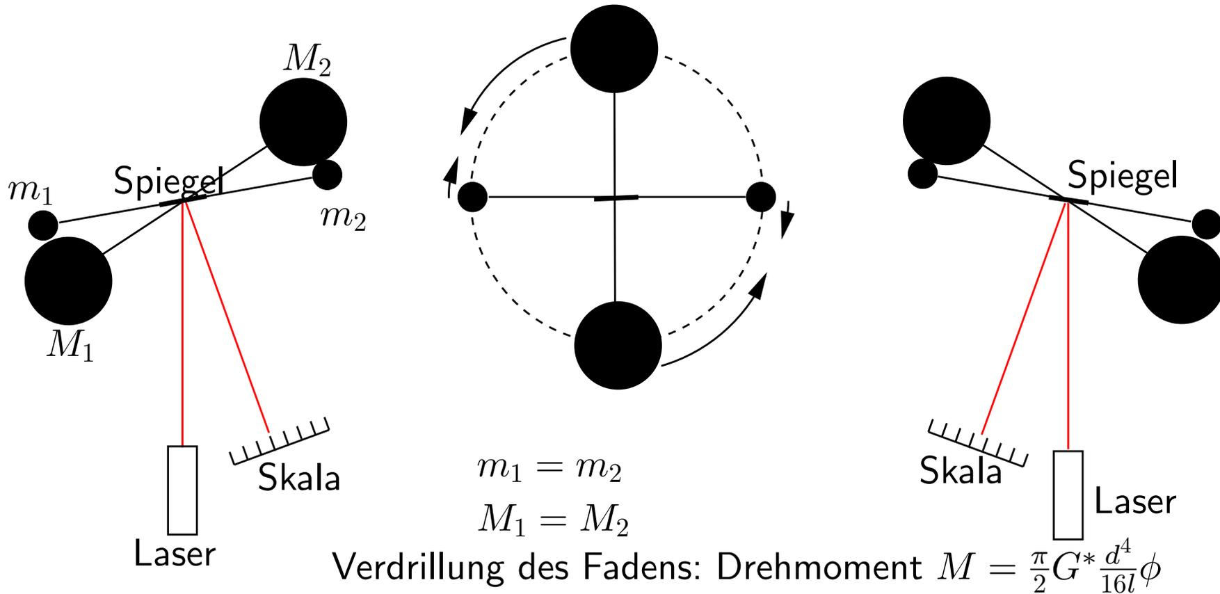
Gleichgewicht des rücktreibenden Drehmomentes  $M$  und des durch die Gravitation
