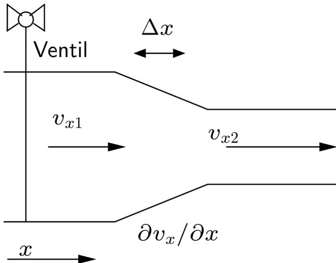
Die Abb. links zeigt eine Flüssigkeitsströmung durch eine Verengung in einem Rohr. Um den Massenfluss konstant zu halten, muss die Geschwindigkeit rechts größer sein als links, die Geschwindigkeit ändert sich über eine Strecke  $\Delta x$  um  $\Delta v = (\partial v_x / \partial x) \Delta x$ .
