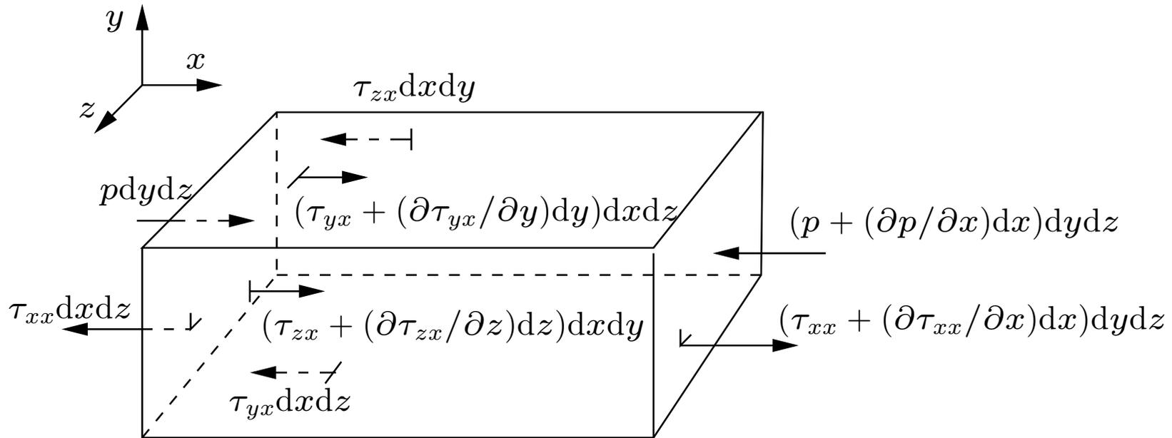
Abbildung 1: Definition der Druck- und Scherkräfte in  $x$ -Richtung auf ein Flüssigkeitelement.
