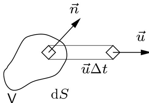
Links ist ein Volumen  $V$  abgebildet, welches deformiert wird.  $dS$  wird um  $\Delta x = \vec{u}\Delta t$  ausgelenkt und die Volumenänderung ist  $\Delta V = (\vec{u}\Delta t) \cdot d\vec{S}$ . Die Volumenänderung  $\Delta V$  pro Zeiteinheit  $\Delta t$  ist
